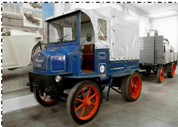
Billede af en Hansa-Lloyd Elektro-Auto Typ. DL 5 – fra Hansa-Lloyd Werke A.G. Bremen-Hastedt. Denne model blev bl.a. brugt til udbringning af pakker i det tyske postvæsen.
